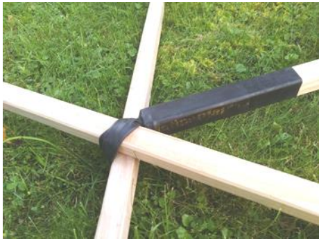
Bild 1: Fahrradschläuche als Klemmverbindungen
